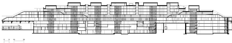
Figure 4.3.2.g Coupe à travers les logements et la rue centrale. Source: Müller Sigrist.
