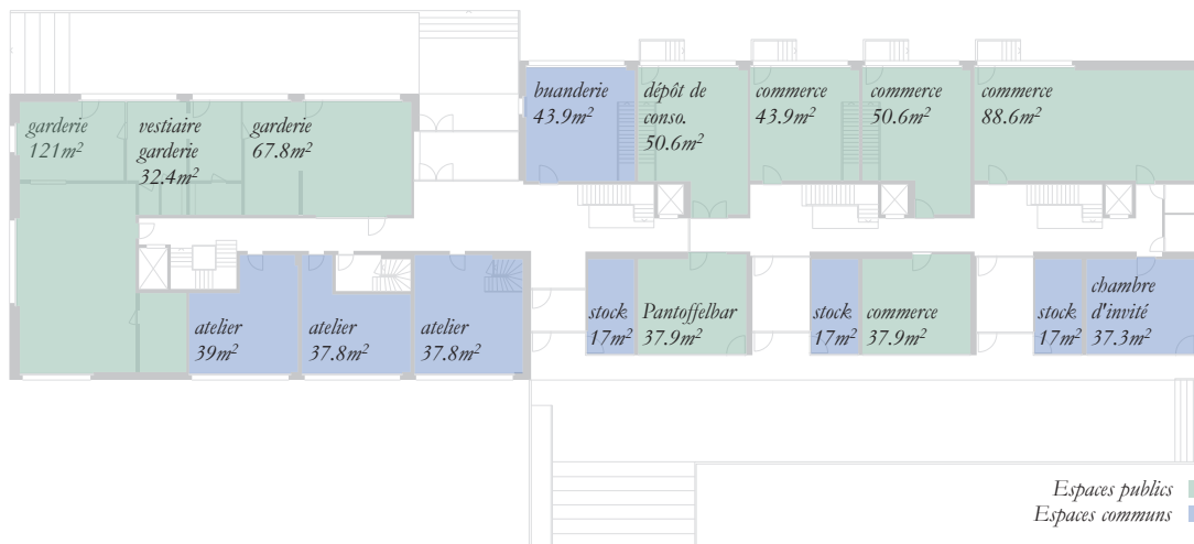
Fig.45 répartition des programmes rez-de-chaussée 1:500
