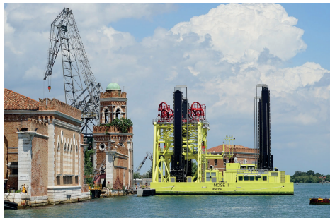
11. Maintenance des barrières mobiles du projet Mose in Venezia, Italy
