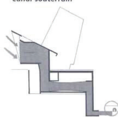
B. Injection d'air frais dans le canal souterrain
