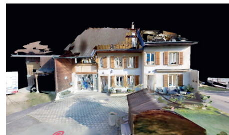
Scan lumière structurée - Le niveau de détails est relativement faible ©3D Swiss View SàRL 3D Swiss View [reproduit avec l'aimable autorisation de l'auteur]
