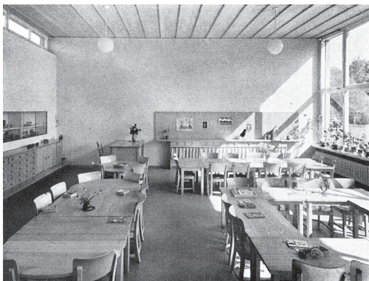
Les salles de classe du Bruderholz disposent d'un éclairage bilatéral assurant ainsi une bonne ventilation. Ci-dessous, photographie d'une leçon donnée en plein air sur la terrasse des préaux.
