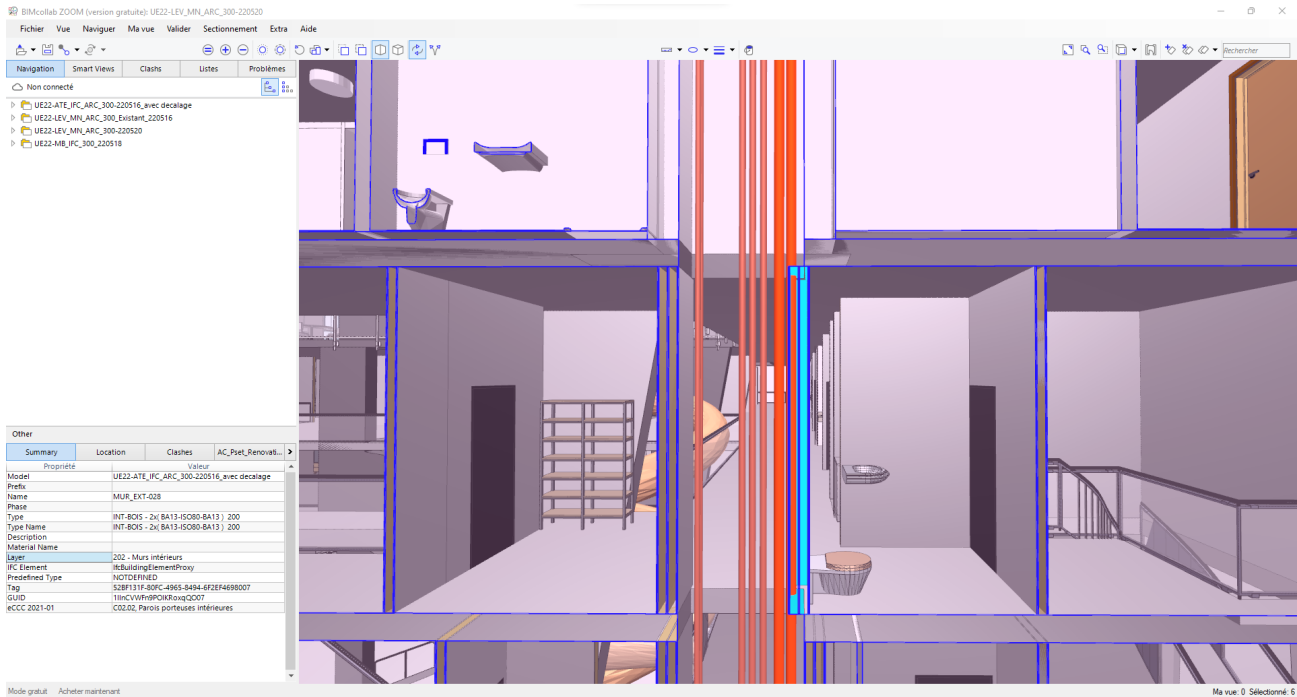
Fig. 15: Détection de clachs entre les maquettes IFC sur BIMCollab.
