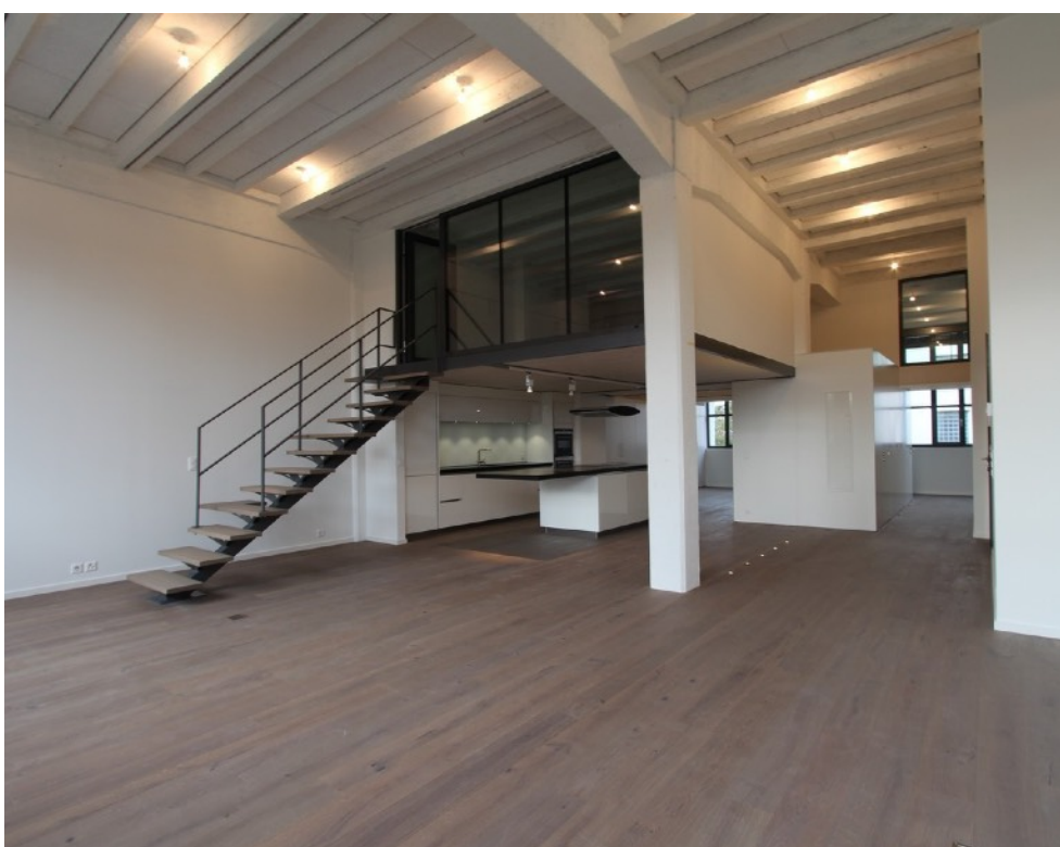
Vues intérieures des lofts. On voit la différence de traitement entre les éléments anciens et nouveaux, le système de boîtes créant des espaces en mezzanine, et les vitrages en partie haute des cloisons. Le caractère industriel de l'espace est encore bien reconnaissable grâce à la présence imposante du système porteur d'origine. © Rainer Solhbank (en haut), Induni & Cie (en bas)
