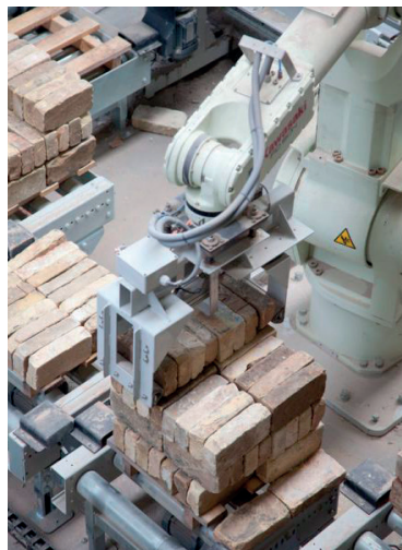
Fig.11 Automatisation du nettoyage des briques par Gamle Mursten
