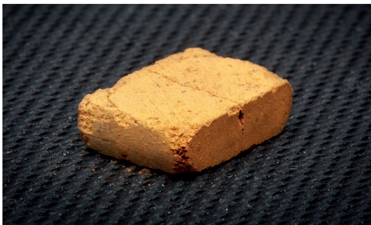
Fig.24 Brique fabriquée à partir d'un sol similaire à celui de Mars. Celle-ci est fissurée, les chercheurs l'ont testée jusqu'à son point de rupture.
