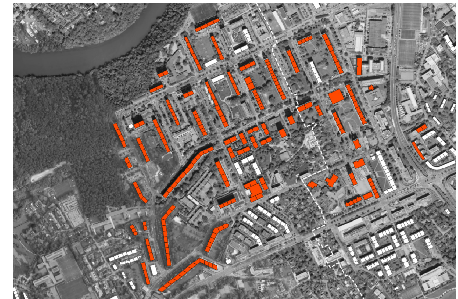
Figure 64 : Bâtiments reliés au réseau CADIOM
