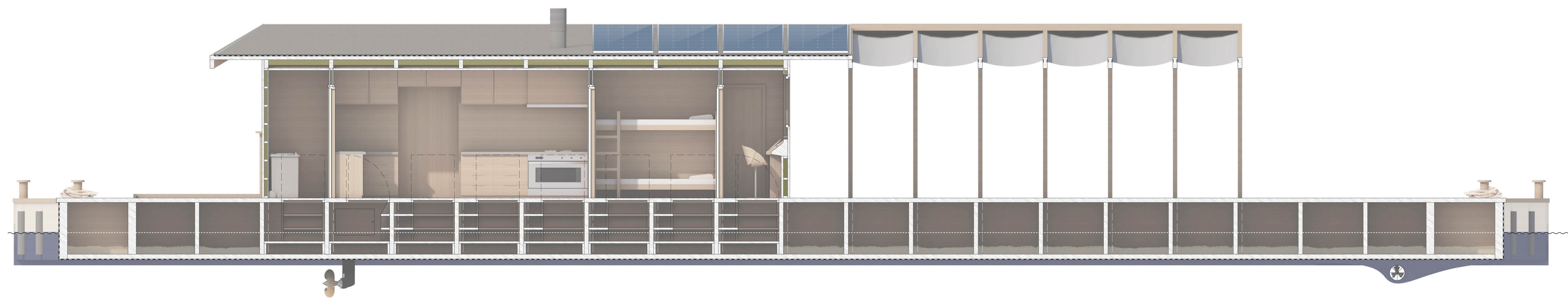
Coupe longitudinale d'une barge 1 m Échelle: 1/25 e
