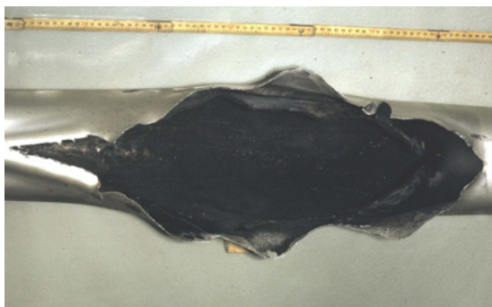
fig g. Le tube de force de l'élément 59, éclaté sous la pression interne
