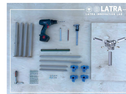
Fig. 161- Assemblage imprimé en 3D pour réutiliser des structure de tente
