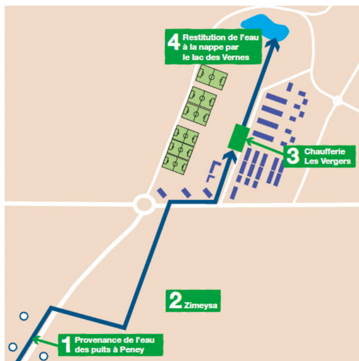
Image 19. Écoquartier Les Vergers: Heating system.
