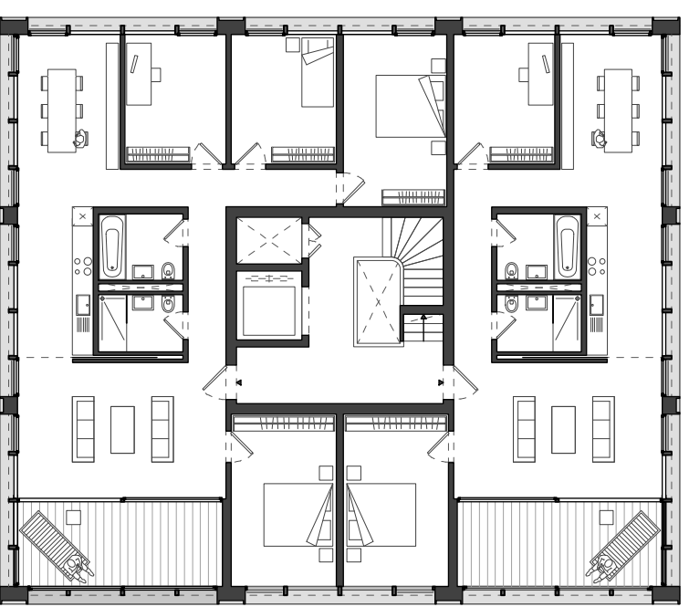
○ Plan étage logement 1:200 Variante avec : 1x appartement 3,5 pièces 1x appartement 5,5 pièces
