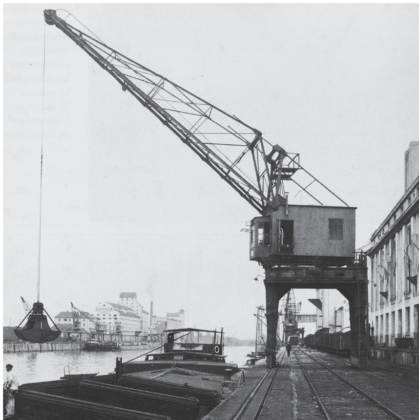
Strasbourg, grue électrique « Demag » de 4 tonnes. (Roblin, 2006)
