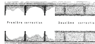
Fig. 69 Digues en épis: construites perpendiculairement au courant, elles permettent de resserrer les lits afin d'accélérer la vitesse de ce dernier. http://fr.wikipedia.org/wiki/Correction_du_Rhone_en_aval_du_lac_L%C3%A9man
