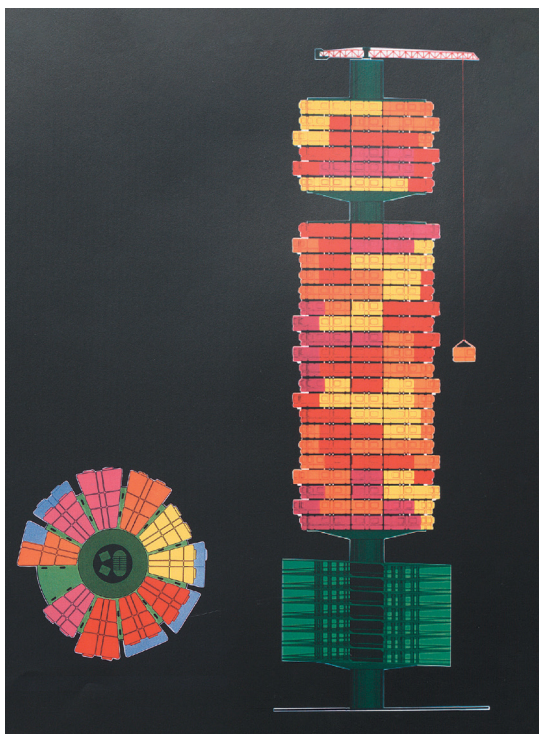
Assemblage des modules habitables autour de la structure à l'aide d'une grue. Archigram, 1964.
