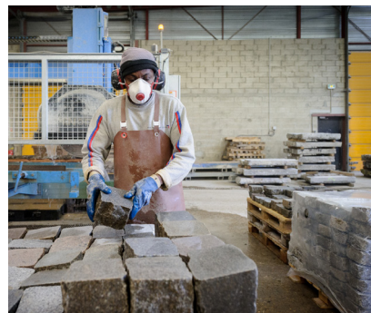
Manutention des pavés de réemploi © genie.ch
