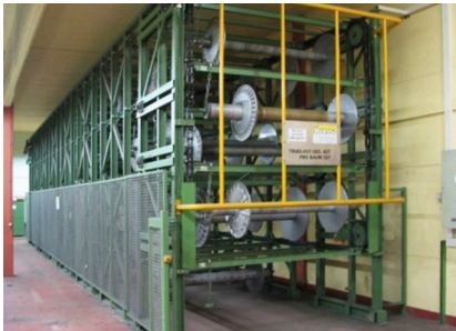
Machine de production de textile dont les profilés sont réutilisée dans la Villa Welpeloo © Superuse Studios
